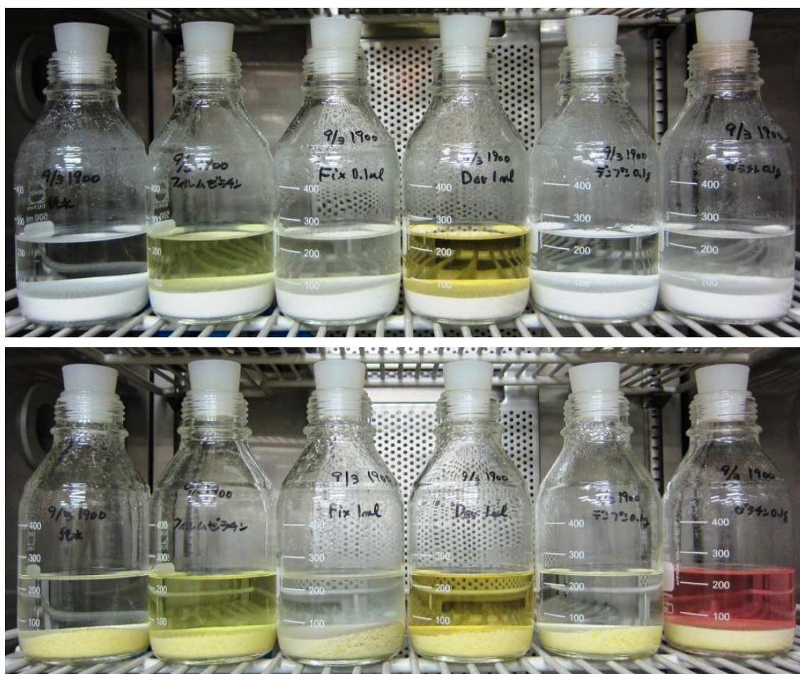
図3 硫化水素発生試験の状況
