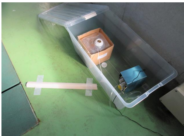
汚泥貯留槽への「光コート」滴下投与
